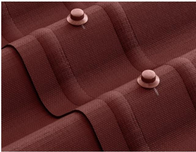
Ондулин SMART оснащен специальным гидрозамком Smart Lock из двух полос, выдавленных по краям листа. Направляющие бороздки регулируют торцевой нахлест и образуют герметичные стыки. Заводская разметка точек крепления облегчает монтаж.
